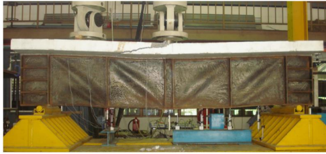
Figura 5.21 – Aspeto final da viga G1C30 [31]
